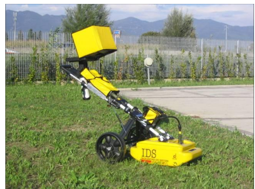
Fig. 8: Immagine dello strumento RIS+ utilizzato per le misure, montato su carrello e completo di antenna.
